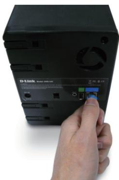
6. Finalmente, conecte el adaptador de poder al conector de energía que se encuentra en la parte posterior del dispositivo.
