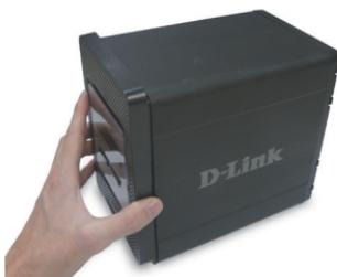
2. Sobald Sie die Abdeckung ausgeklinkt haben, ziehen Sie sie von dem Gerät. Die Laufwerkeinschübe sind nun sichtbar.
