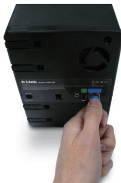
6. Stecken Sie dann den im Lieferumfang enthaltenen Stromadapter an die Stromanschlussbuchse auf der Rückwand des Gerätes.
