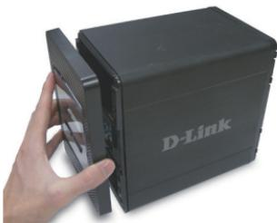
3. Inserire un'unità disco SATA da 3,5" SATA in uno slot disponibile. Prestare attenzione ad allineare il connettore dell'unità all'estremità del dispositivo DNS-343. Premere delicatamente sull'unità finché non risulta collegata. Ripetere la procedura per ogni unità da inserire nel dispositivo.
