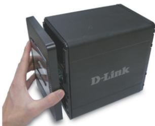
3. Schieben Sie eine 3.5" SATA-Festplatte in einen verfügbaren Laufwerkeinschub ein. Stellen Sie dabei sicher, dass der Laufwerkanschluss am Endpunkt des DNS-343 ausgerichtet ist. Drücken Sie das Laufwerk dann leicht weiter in den Einschub, bis die Festplatte eingerastet ist. Wiederholen Sie den Vorgang für jedes Laufwerk, das Sie in das DNS-343 einsetzen.
