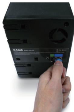
6. Infine, collegare l'alimentatore fornito all'apposita presa presente sul retro del dispositivo.
