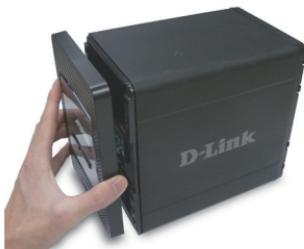
3. Insérez un disque dur SATA de 3,5 pouces dans une baie disponible. Veillez à bien aligner les connecteurs du disque avec les points de connexion du DNS-343. Insérez délicatement le disque jusqu'à ce qu'il se connecte. Répétez l'opération pour chaque disque que vous souhaitez installer dans le DNS-343.
