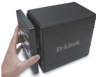
3. Inserte un disco de 3.5" SATA en una bahía disponible. asegúrese de alinear los conectores del disco a las terminaciones en el DNS-343. Suavemente empuje el disco adentro hasta que conecte. Repita para cada disco que quiera conectar en el DNS-343.
