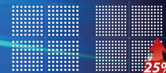
256QAM 8bits per symbol
