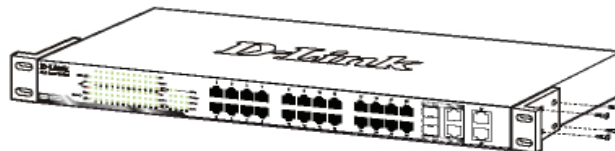
Figure 2. Fixation des supports de montage
