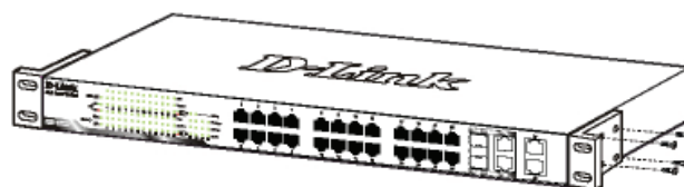
Figura 2. Fissaggio delle staffe di montaggio
