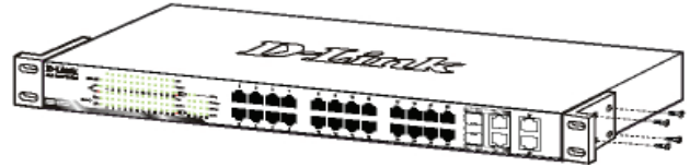
Figura 2. Fixando as braçadeiras de montagem
