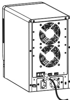
6. Schließen Sie das Netzkabel (Stromadapter) an die Steckdose an.
