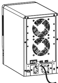
6. Collegare l'alimentatore fornito alla presa elettrica.
