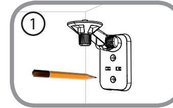
Utilisez les outils appropriés pour percer deux trous de même diamètre que les chevilles en plastique. Ensuite, insérez les chevilles en plastique dans les trous percés pour soutenir les vis.
