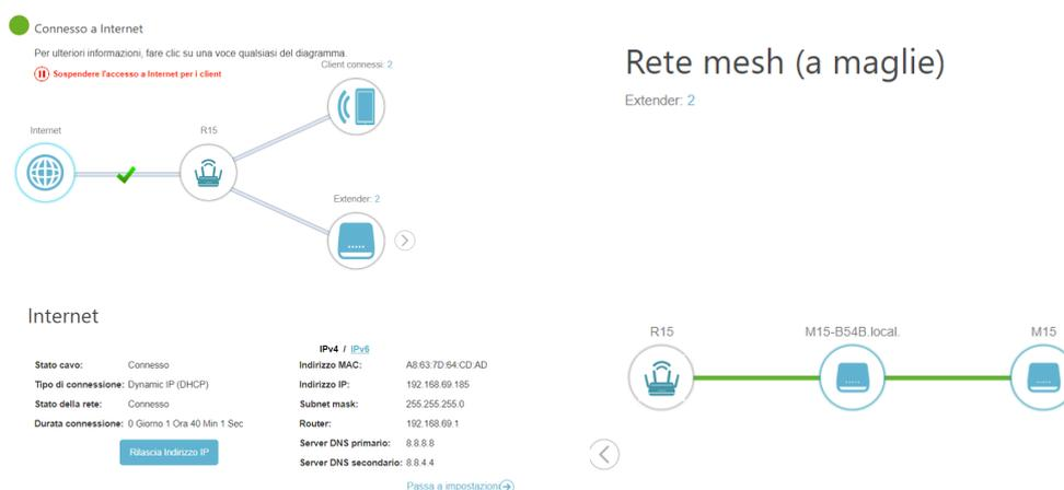
La nostra tecnologia Smart Roaming crea un'unica rete SSID senza interruzioni che garantisce che i tuoi apparecchi siano collegati automaticamente al segnale più forte possibile, in modo da avere sempre la migliore connessione mentre ti muovi, senza doverti preoccupare dei punti morti e delle zone dove il segnale è debole.
