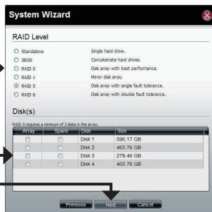
**Étape 8 :** Choisissez d'activer ou de désactiver la fonction de reconstruction automatique de RAID 1, RAID 5 ou RAID 6.
