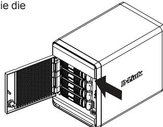
3. Legen Sie eine 3.5" SATA-Festplattenlaufwerk in ein Laufwerkeinschubfach und sichern Sie das Festplattenlaufwerk an dem Fach mithilfe der Schrauben. Zum Anbringen der Schrauben finden Sie vier Löcher. Zwei sind in dem Bild durch einen roten Kreis gekennzeichnet und die anderen zwei Löcher befinden sich auf der anderen Seite des Laufwerkfachs.
