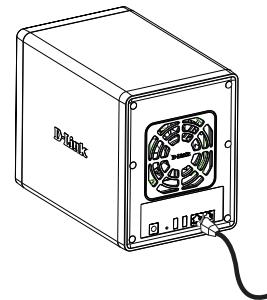
6. Schließen Sie das im Lieferumfang des Produkts enthaltene Netzkabel an die Stromversorgung an.
