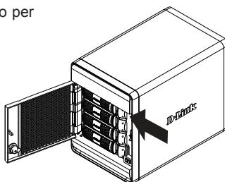
3. Inserire un'unità disco rigido SATA da 3,5" in un cassetto per unità e utilizzare le viti per fissare l'unità al cassetto. Sono presenti quattro fori per il fissaggio delle viti. Due fori sono cerchiati in rosso nell'immagine, mentre gli altri due si trovano sull'altro lato del cassetto.
