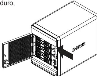
3. Coloque un disco duro de 3,5" SATA en una bandeja de unidad y utilice los tornillos para sujetar el disco duro a la bandeja. Hay cuatro orificios para sujetar los tornillos. En la imagen, dos orificios aparecen con un círculo rojo, y los otros dos orificios están en el otro lado de la bandeja de la unidad.
