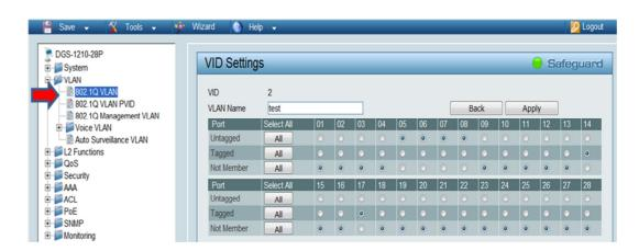
Note : les ports taggés sont les ports d'interconnexions qui permettent la diffusion des VLAN's.
