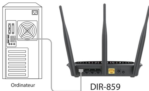
4. Branchez une extrémité du câble Ethernet joint au routeur dans le port jaune étiqueté INTERNET à l'arrière du routeur. Branchez l'autre extrémité de ce câble au port Ethernet de votre modem.
