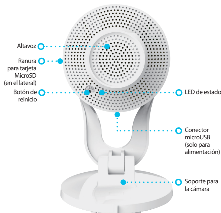
Vista de las conexiones
