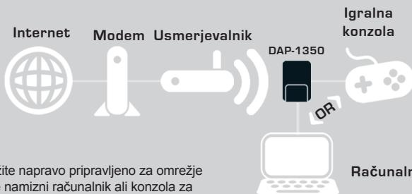
Povežite napravo pripravljeno za omrežje (kot je namizni računalnik ali konzola za igre) z Wi-Fi omrežjem
