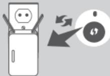
Vtaknite DAP-1620 v električno vtičnico in počakajte dokler LED lučka Status/WPS ne utripa rumeno. Pritisnite gumb WPS na izvirnem brezžičnem usmerjevalniku ali AP-ju in nato pritisnite WPS na DAP-1620. LED lučka Status/WPS bo začela utripati zeleno.
