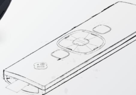
Trekk plastfliken ut av fjernkontrollen for å aktivere batteriet.
