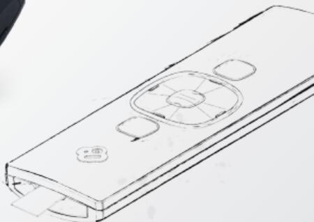
Retirez la languette en plastique de la télécommande pour activer la pile.
