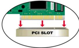
**Nota:** Para evitar descargas electrostáticas, toque un tornillo sin pintar de la parte externa de la fuente de alimentación antes de instalar o trabajar con el DGE-528T
