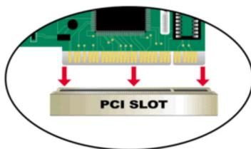
**Замечание:** Во избежание эффекта разряда статического напряжения, пожалуйста, коснитесь незаизолированного винта на обратной стороне блока питания компьютера прежде, чем устанавливать DGE-528T.
