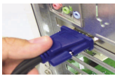
I. Sæt KVM-kablet (VGA-stikket) i VGA-porten, der sidder bag på computerens kabinet.
