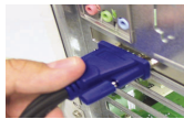
I. Podłącz złącze VGA kabla KVM do portu VGA z tyłu komputera .
