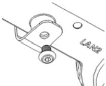
Utilisez la vis de montage incluse (trou hexagonal) pour verrouiller le DAP-3662 au support de montage sur le poteau/mur
