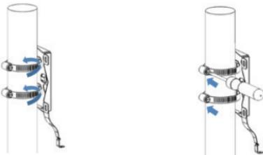
Fixez le socle de montage au poteau avec les deux colliers de serrage en acier inoxydable. Assurez-vous que le collier de serrage est bien verrouillé.
