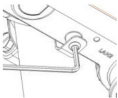
Con la llave Allen hexagonal, apriete el tornillo de montaje hasta que el DAP-3662 esté asegurado.
