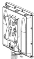
Una vez alineado, deslice hacia abajo el dispositivo de modo que la placa de montaje queda bien bloqueada en el DAP-3662
