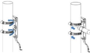
Befestigen Sie die Montageplatte mithilfe der zwei rostfreien Halterungsgurte. Vergewissern Sie sich, dass die Gurte fest und sicher angebracht sind.
