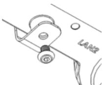
Utilice el tornillo de montaje incluido (orificio hexagonal) para bloquear el DAP-3662 en el montaje para poste/pared
