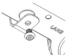
Utilizzare la vite di montaggio inclusa (foro esagonale) per bloccare il punto di accesso DAP-3662 alla base di montaggio su asta o a parete
