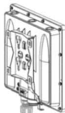
Una volta allineato, far scivolare il dispositivo all'indietro in modo che la piastra di montaggio si incastri nel punto di accesso DAP-3662
