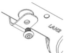
Befestigen Sie den DAP-3662 an der Mast-/Wandmontageplatte, indem Sie die im Lieferumfang enthaltene Befestigungsschraube (Innen-Sechskant) verwenden
