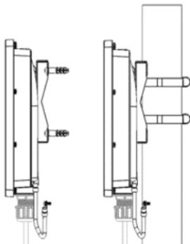
Conecte el otro extremo del cable de conexión a tierra al montaje para pared o para poste. Asegúrese de que el montaje para pared o para poste está conectado a una toma de tierra eléctrica.
