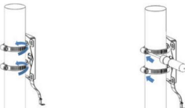
Fissare la base di montaggio all'asta con le due
