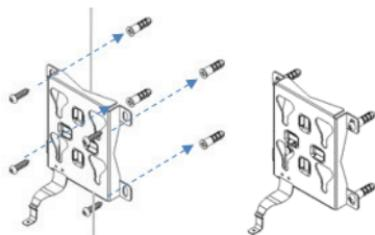
Bringen Sie die Montageplatte mithilfe der Dübel und Schrauben an der Wand an.
