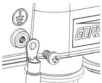
Fixez le câble de mise à la terre au DAP-3662 à l'aide des vis incluses.
