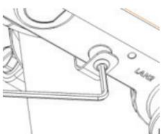
Ziehen Sie die Befestigungsschraube mit dem mitgelieferten Inbusschlüssel an, bis der DAP-3662 fest und sicher angebracht ist.
