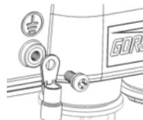
Bringen Sie das Erdungskabel unter Verwendung der mitgelieferten Schraube an dem DAP-3662 an.
