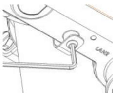
Avec la clé Allen incluse, serrez la vis de montage jusqu'à ce que le DAP-3662 soit bien fixé.
