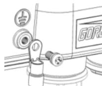
Fissare il cavo di messa a terra al punto di accesso DAP-3662 utilizzando la vite inclusa.
