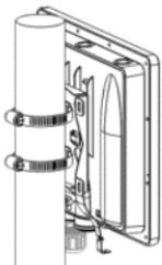
Schieben Sie das Gerät nach ordnungsgemäßer Ausrichtung nach unten, so dass die Montageplatte sicher und fest in den DAP-3662 eingepasst ist.
