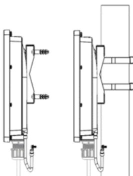
Collegare l'altra estremità del cavo di messa a terra alla base di montaggio a parete o su asta. Assicurarsi che la base di montaggio a parete o su asta sia collegata a un componente dotato di messa a terra.
