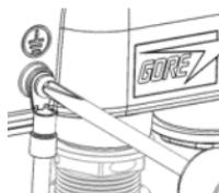
Ziehen Sie die Schraube am DAP-3662 an, bis das Erdungskabel sicher angebracht ist.
