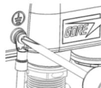
Serrez la vis du câble de mise à la terre au DAP-3662 jusqu'à ce que la câble soit bien fixé.
