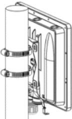
Una volta allineato, far scivolare il dispositivo all'indietro in modo che la piastra di montaggio si incastri nel punto di accesso DAP-3662
