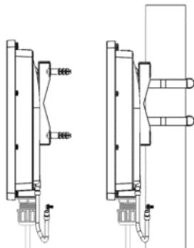
Fixez l'autre extrémité du câble de mise à la terre au support de montage sur le mur ou le poteau. Assurez-vous que le support de montage sur le mur ou le poteau est relié à une masse électrique.
