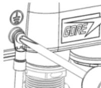
Apriete el cable de conexión a tierra al DAP-3662 hasta que esté sujeto de forma segura.
