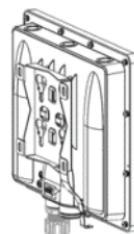
Schieben Sie das Gerät nach ordnungsgemäßer Ausrichtung nach unten, so dass die Montageplatte sicher und fest in den DAP-3662 eingepasst ist.
