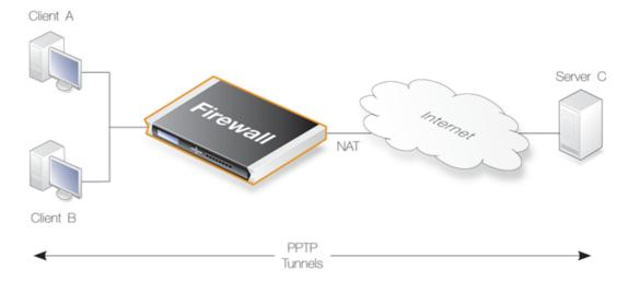
Figure 6.6. PPTP ALG Usage
