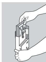
4. Držeći DNS-315 u uspravnom položaju, umetnите tvrdi disk od 3,5" u pogonski odjeljak uređaja. (SATA priključak treba biti u ravnini sa SATA utičnicom na bazi uređaja jer u suprotnom napajanje uređaja DNS-315 neće biti ispravno).
