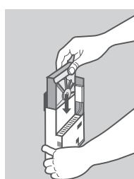
4. Låt DNS-315-enheten stå kvar i uppått läge och sätt i en kompatibel 3,5-tums hårddisk i enheten enhetsfack. (Kontrollera att SATA-kontakten är i linje med SATA-sockeln i enhetens bas annars går det inte att slå på DNS-315-enheten).
