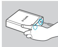
1. Verwenden Sie einen Schraubendreher (nicht Teil des Lieferumfangs), um die zwei Schrauben auf der Unterseite des DNS-315 zu lösen.
