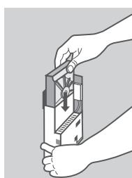
4. Držite DNS-315 v navpičnem položaju in vstavite ustrezni trdi disk od 3,5" v režo za pogon v napravi. (Zagotovite, da je priključek SATA poravnан z vtičnico SATA v podnožju naprave. V nasprotnem primeru DNS-315 ne bo deloval pravilno).
