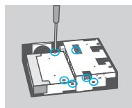
5. Használja minden a hat szállított csavart a merevlemez alapegységehez való biztosításához.
