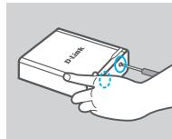
1. Χρησιμοποιήστε ένα κατσαβίδι (δεν παρέχεται στο κουτί) για να ξεβι δώσετε τους δύο κοχλίες στο κάτω μέρος του DNS-315.
