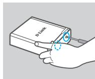
1. Utilisez un tournevis (non fourni) pour desserrer les deux vis situées sous le DNS-315.
