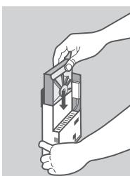
4. Manteniendo el DNS-315 en posición vertical, introduzca un disco duro de 3,5" compatible en la bahía de la unidad del dispositivo. (Asegúrese de que el conector SATA está alineado con el enchufe del SATA en la base de la unidad de lo contrario, el DNS-315 no se encenderá correctamente).
