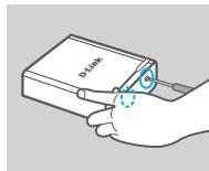
8. Kiinnitä DNS-315:n pohjassa olevat ruuvit uudelleen.
