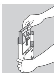
4. Menținând dispozitivul DNS-315 în poziție verticală, inserați un hard disk de 3,5" compatibil în compartimentul pentru unități al dispozitivului. (Asigurați-vă de alinierea conectorului SATA cu soclul SATA de la baza unității, în caz contrar dispozitivul DNS-315 nu va porni corect).
