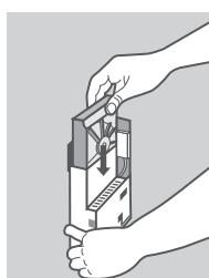
4. Halten Sie den DNS-315 in aufrechter Position und setzen Sie eine kompatible 3,5" Festplatte in den Laufwerkschacht des Geräts ein. (Vergewissern Sie sich, dass der SATA-Anschluss an der SATA-Buchse an der Basis der Einheit ausgerichtet ist, sonst wird der DNS-315 nicht korrekt hochgefahren.)
