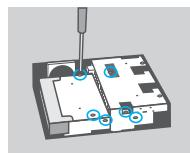
5. Utilizzare tutte le sei viti fornite per fissare l'unità disco rigido all'unità base.
