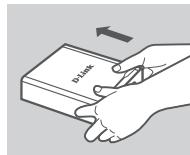
2. Przesuwaj górną osłonę urządzenia aż odepnie się od podstawy (kierunek wskazany jest na logo D-Link).
