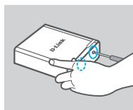
8. Resserrez les vis du dispositif au-dessous du DNS-315.
