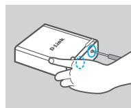
1. Schroef de twee schroeven onderaan in de DNS-315 los met een schroevendraaier (niet meegeleverd in doos).
