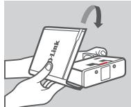
6. Déle la vuelta hacia atrás a la cubierta para alinearla con la línea roja del soporte.
