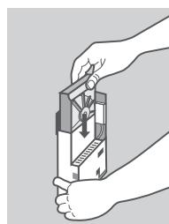
4. Houd de DNS-315 rechtop en plaats een compatibele 3.5" vaste schijf in het schijfstation van het toestel. (Zorg dat de SATA connector uitgelijnd is met de SATA-stekker op de voet van het toestel zoniet kan de DNS-315 niet correct opstarten).
