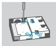
5. Verwenden Sie alle sechs mitgelieferten Schrauben zum Anbringen des Festplattenlaufwerks an der Basiseinheit.
