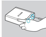
8. Ricollegare le viti nella parte inferiore del dispositivo DNS-315.
