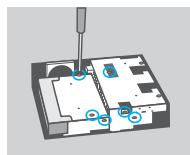
5. Utilize os seis parafusos para fixar o disco rígido na unidade base.
