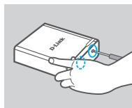
8. Bevestig de schroeven van het apparaat opnieuw aan de onderkant van de DNS-315.
