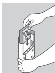
4. pidä DNS-315 pystyasennossa ja asenna yhteensopiva 3,5 tuuman kiintolevy laitteen levypaikkaan. (Varmista, että SATA-liitin on kohdistettu SATA-liittimeen laitteen alustassa. Muuten DNS-315 ei käynnisty oikein.)
