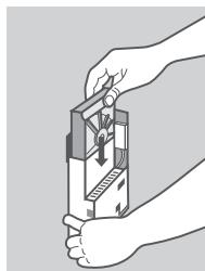
4. Tout en maintenant le DNS-315 en position verticale, insérez un disque dur de 3,5" compatible dans la baie du périphérique (vérifiez que le connecteur SATA est aligné avec le socket correspondant, situé sur la base de l'appareil ; sinon, le DNS-315 ne s'allumera pas correctement).
