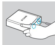
1. Con un cacciavite (non fornito nella confezione) svitare le due viti nella parte inferiore del dispositivo DNS-315.
