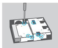
5. Använd alla de sex medföljande skruvarna för att skruva fast hårddisken i basenheten.
