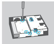
5. Tvrdi disk pričvrstite na osnovnu jedinicu uz pomoć svih šest isporučenih vijaka.
