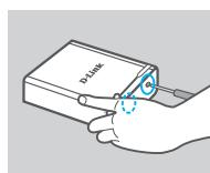
8. Volte a colocar os parafusos do dispositivo na parte inferior do DNS-315.
