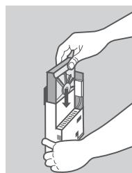
4. Tenendo il dispositivo DNS-315 in posizione verticale, inserire un'unità disco da 3,5" compatibile nello slot del dispositivo. Assicurarsi che il connettore SATA sia allineato alla presa SATA nella base dell'unità. In caso contrario, il dispositivo DNS-315 non si accenderà correttamente.
