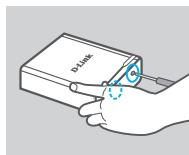
8. Vuelva a colocar los tornillos del dispositivo en la parte inferior del DNS-315.
