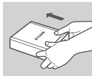
2. Retirez le capot supérieur en le faisant glisser loin de vous jusqu'à ce qu'il se décroche de sa base (notez l'orientation du logo D-Link sur l'image pour vérifier le sens).
