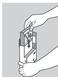
4. A DNS-315-öt egyenesen tartva helyezzen be egy kompatibilis 3,5" merevlemezét az eszköz meghajtórekeszébe. (Győződjön meg arról, hogy a SATA konnektor a SATA aljzatához van igazítva az egység alapzatán, máskülönben a DNS-315 nem fog megfelelően bekapcsolni).
