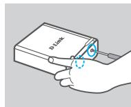
1. Użyj wkrętaka (nieznajdującego się w pudełku), aby odkręcić dwie śruby znajdujące się w dolnej części urządzenia DNS-315.
