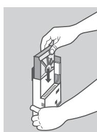
4. Podržte zařízení DNS-315 nastojato a do slotu pro disk vložte kompatibilní 3,5" pevný disk. (Dbejte, aby konektor SATA lícoval s páteří SATA v základně jednotky, jinak se DNS-315 správně nezapne.)
