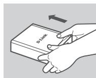
2. Glisați capacul superior în direcție opusă celei în care vă aflați până când se desprinde de pe bază (rețineți direcția siglei D-Link din imagine pentru a verifica direcția).
