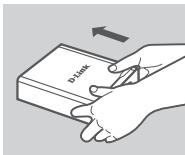
2. Deslice la cubierta superior separándola de usted hasta que se desenganche de la base (observe la dirección del logotipo de D-Link en la imagen para comprobar la dirección).
