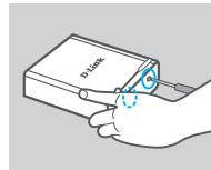
1. Bruk en skrutrekker (følger ikke med) til å skru ut de to skruene på undersiden av DNS-315.
