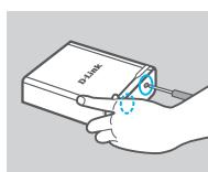
8. Atașați din nou șuruburile dispozitivului pe partea inferioară a dispozitivului DNS-315.
