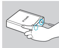
1. Utilize uma chave de parafusos (não fornecida na embalagem) para remover os dois parafusos na parte inferior do DNS-315.
