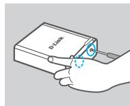
1. Utilizați o șurubelnită (nu este furnizată în cutie) pentru a deșuruba cele două șuruburi de pe partea inferioară a dispozitivului DNS-315.
