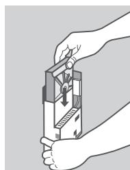
4. Trzymając DNS-315 w pozycji pionowej, włóż kompatybilny 3,5-calowy dysk twardy w kieszeń dyskową urządzenia. (Upewnij się, że złącze SATA jest podłączone do gniazda SATA w podstawie urządzenia. W przeciwnym razie DNS-315 nie włączy się poprawnie.)
