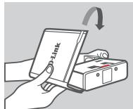
6. Schlagen Sie die Abdeckung zurück, um sie an der roten Linie an dem Bügel auszurichten.
