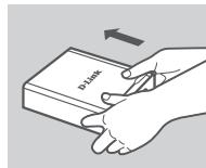
2. Deslize a tampa superior para longe de si até que se desprenda da base (tenha em atenção a direcção do logótipo D-Link na imagem, para verificar a direcção).
