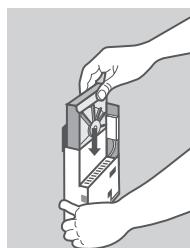
4. Mantendo o DNS-315 na posição vertical, insira um disco rígido de 3.5" compatível no compartimento de discos do dispositivo. (Verifique que o conector SATA está alinhado com a entrada SATA na base do dispositivo, caso contrário, o DNS-315 não ligará correctamente).
