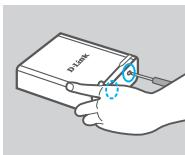
1. Utilice un destornillador (no suministrado en el paquete) para desatornillar los dos tornillos de la parte inferior del DNS-315.
