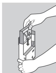
4. Mens DNS-315 holdes i opret stilling, indsættes et kompatibelt 3.5" harddiskdrev i enhedens drevbakke. (Kontrollér, at SATA-stikket flugter med SATA-soklen bagest i enheden ellers vil DNS-315 ikke starte korrekt).
